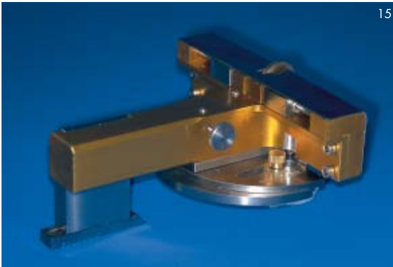
Abb. 15 bis 18 Der CranialPointer mit eingesetzter und herausgenommener Fixierplatte. Die Dorsalpointer und der Frontpointer zum Abgreifen der Referenzpunkte am Modell. Die L-Aussparungen unterhalb der Fixierplatte.
