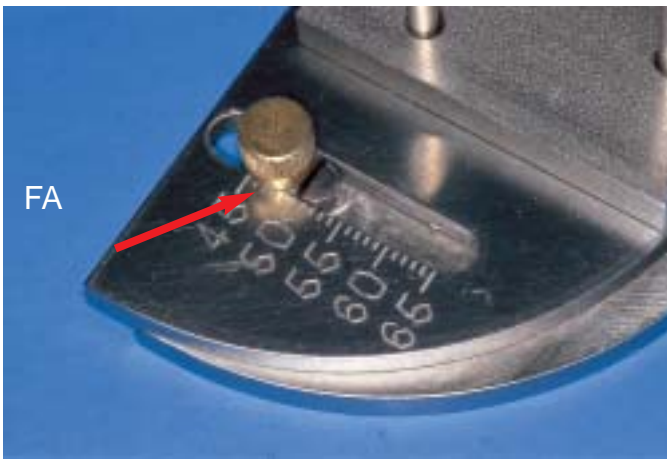
Abb. 26 Am Transfersockel wird der Frontzahnabstand (FA) eingestellt.
