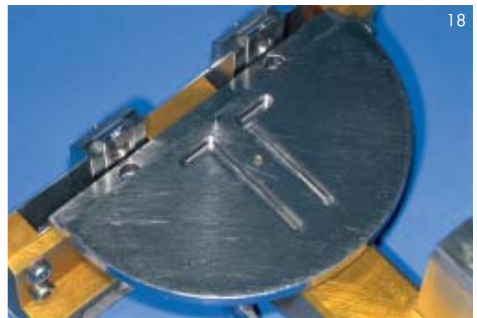
Abb. 15 bis 18 Der CranialPointer mit eingesetzter und herausgenommener Fixierplatte. Die Dorsalpointer und der Frontpointer zum Abgreifen der Referenzpunkte am Modell. Die L-Aussparungen unterhalb der Fixierplatte.
