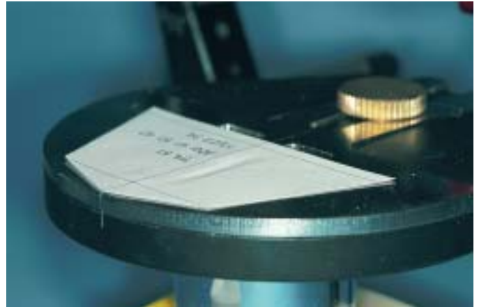
Abb. 24 Auf den Cranialtisch des CSP-Transfersockels wird der Ausdruck des rekonstruierten Zahnbogenverlaufs geklebt.
